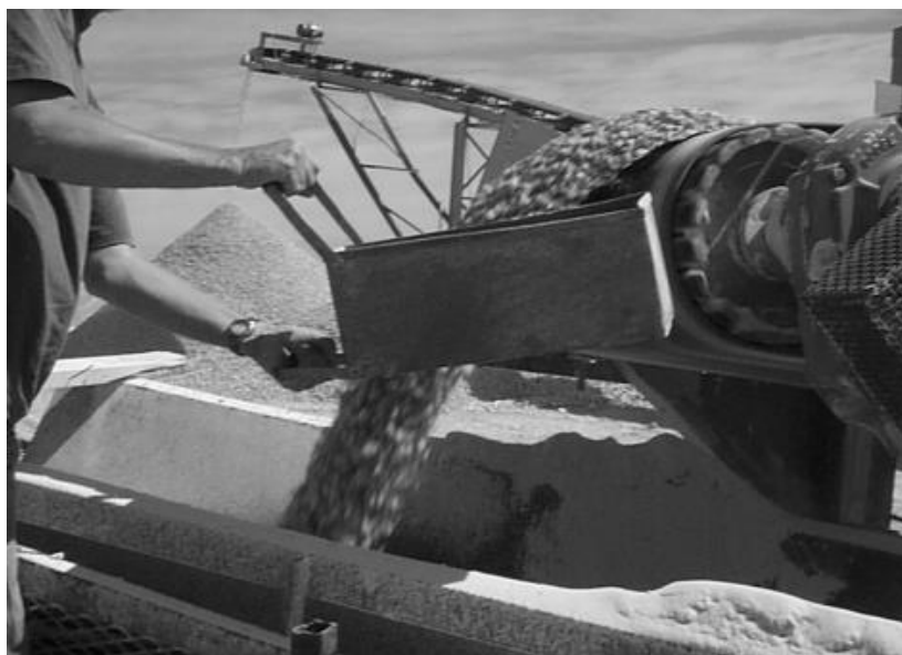
Figura 201 - 1. Muestreo en un flujo de descarga
