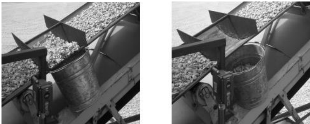
Figura 201 - 2. Muestreo en una banda transportadora
